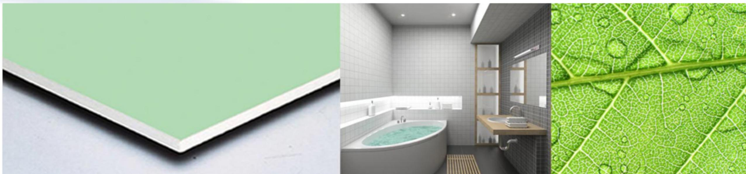
Une plaque de couleur verte dont l'âme et les deux parements ont été hydrofugés de niveau H1- absorption superficielle  $\leq 160 \text{ g/m}^2$  après 2 heures - reprise d'eau  $\leq 5 \%$  en poids après 2 heures.
